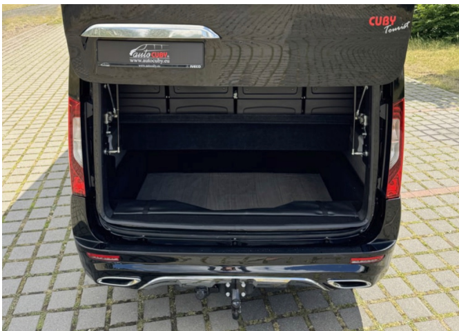
Allegato 5 - Posteriore - Bagagliera sfondata con predisposizione per gancio traino
